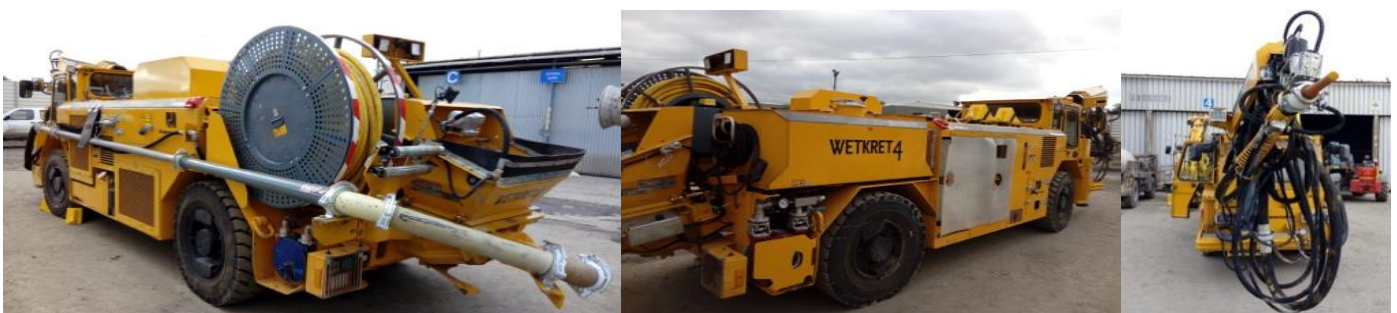
Figura 3: Robot de Projecção de betão.
